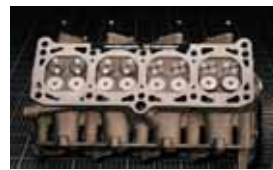
1976: Der erste 16 Ventil-Motor der Welt The first 16 valve-engine in the world
