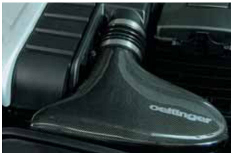
Carbon Ram Air Staudrucksammler mit Sportluftfilterkit
