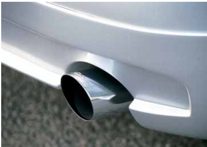
Endschalldämpfer links/rechts aus Edelstahl Endrohre 1 x 84 mm
