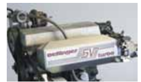
1989: Der weltweit erste 20-Ventil-Motor Worldwide first 20 valve-engine
