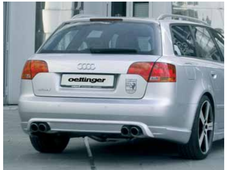
4-Rohr-Endschalldämpfer mit 76 mm-Endrohren
