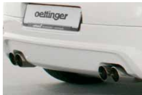
4-Rohr-Endschalldämpfer 4-Pipe rear silencer mit OETTINGER-Heckschürze with OETTINGER-rear-skirt
