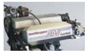
1989: Der weltweit erste 20-Ventil-Motor Worldwide first 20 valve-engine
