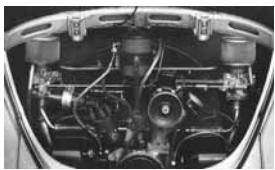
1950: Der legendäre Käfer TSV-Motor The legendary TSV-Engine for the „bug“
