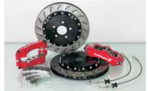
4- und 6-Kolben Sportbremsanlage 4- and 6-caliper High performance brake kit diverse Varianten multiple versions Bremscheiben brake disc from von 320 bis 372 mm 320 to 372 mm
